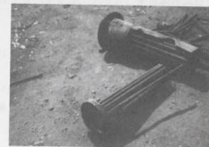
汚染された熱交換器
